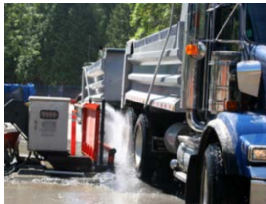
Dekkjaþvottavél sem æskilegt er að nota á framkvæmdasvæðum.
