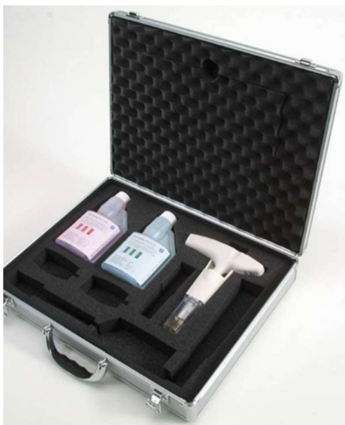
Mynd 6. Áltaska með samsettum hita- og sýrustigsmæli sem er með gel-loki á. Einnig eru stillingarvökvar í töskunni.
