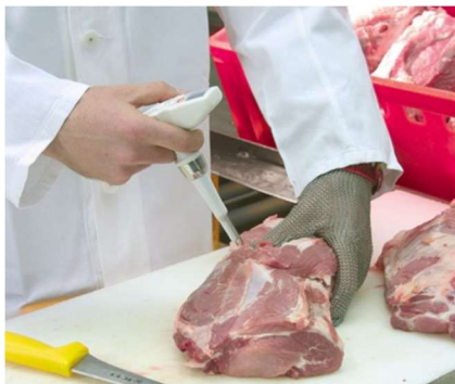
Mynd 11. Testo 205 mælir notaður til að mæla sýrustig í vöðva.
