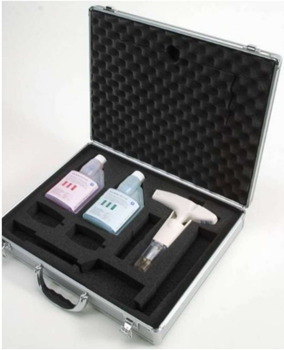
Mynd 1. Áltaska með samsettum hita- og sýrustigsmæli sem er með gel-loki á. Einnig eru kvörðunarlausnir í töskunni.
