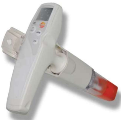
Mynd 9. Samsettur hita- og sýrustigsmælir í slíðri með elektróðu og hitamæli í geymslugeli.
